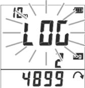
Sie hören einen kurzen Piepton. Das LOG beginnt zu blinken, die Aufzeichnungsnummer erhöht sich um 1. Kurzes Drücken der Tasten bewirkt keine Reaktion. Der Bildschirm wird nach 10 Sekunden ausgeblendet.
